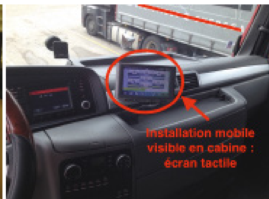
Figure 2 : Installation mobile du SIE à l'usage des conducteurs
